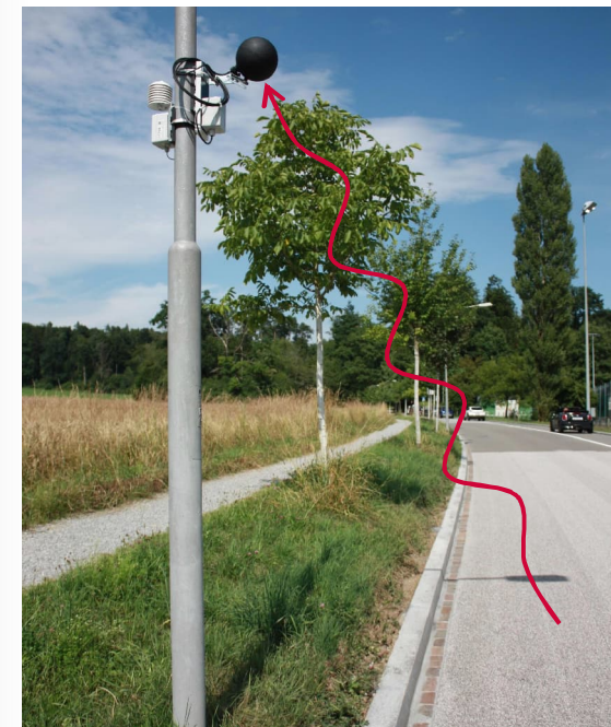
Messung reflektierter Strahlung anhand eines Black Globes über einem kühlen Strassenbelag.
